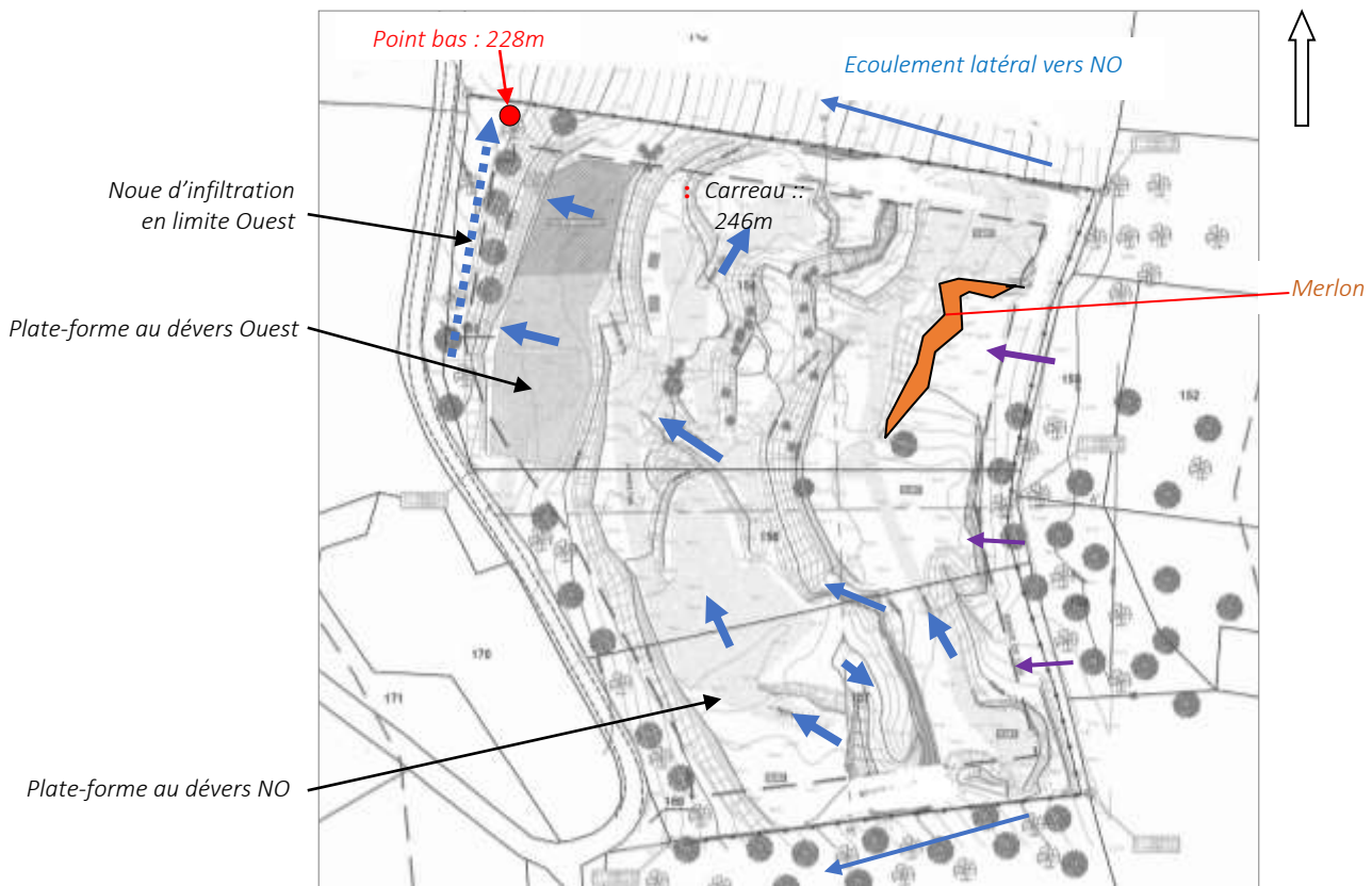
PL.17 : Schéma cartographique des écoulements d'eau pluviale dans la carrière
