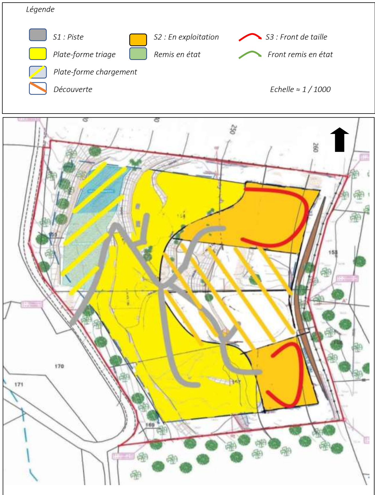
Pl.34 : Schéma des surfaces cartographiques S1, S2 et S3 pour le calcul des garanties financières Période 1 : 0 à 5 ans
